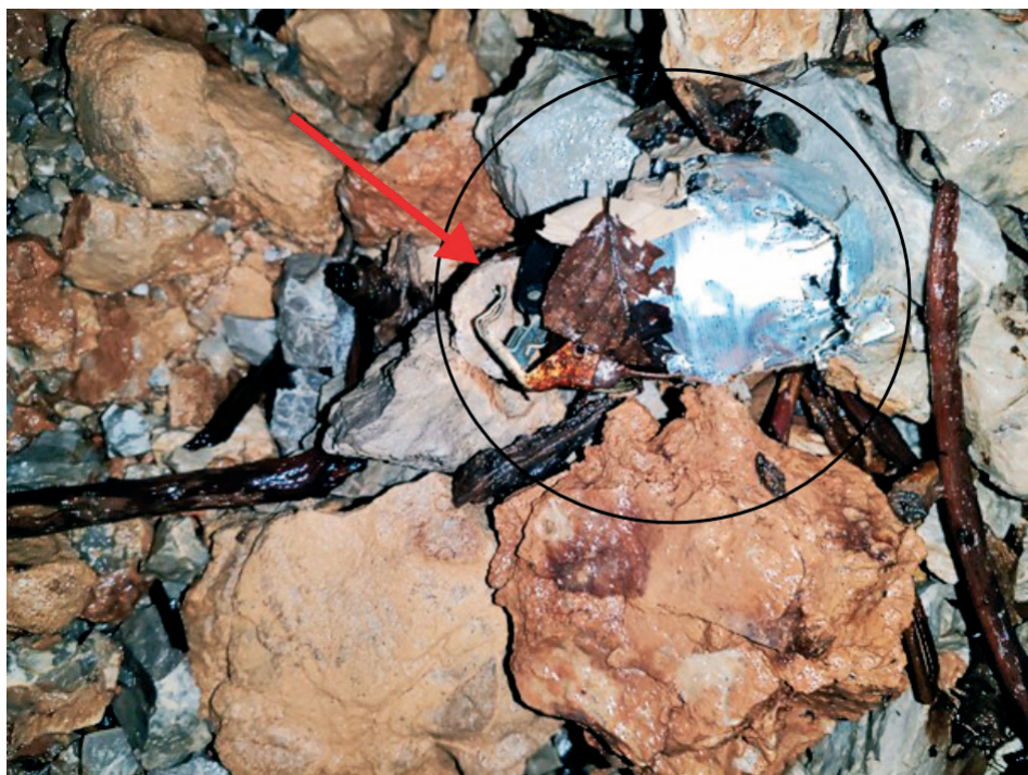
Slika 11. Izuzetno opasna situacija u kojoj je na dnu jame ručna granata M75 djelomično prekrivena lišćem. Crvena strelica označava oštećeni osigurač eksplozivnog sredstva. Detonaciju sprječava jedino plastična folija kojom je omotana granata zajedno s tzv. žlicom. Najmanji pomak ovakvog sredstva može izazvati eksploziju. (Foto: MUP)
