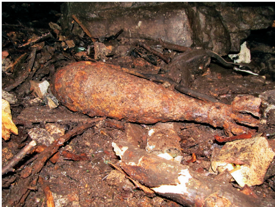
Slika 6. Desetljeća hrdanja na dnu jame ostavljaju trag na površini, no mehanizam aktivacije minsko-eksplozivnog sredstva potpuno je očuvan. (foto: Ruder Novak)
